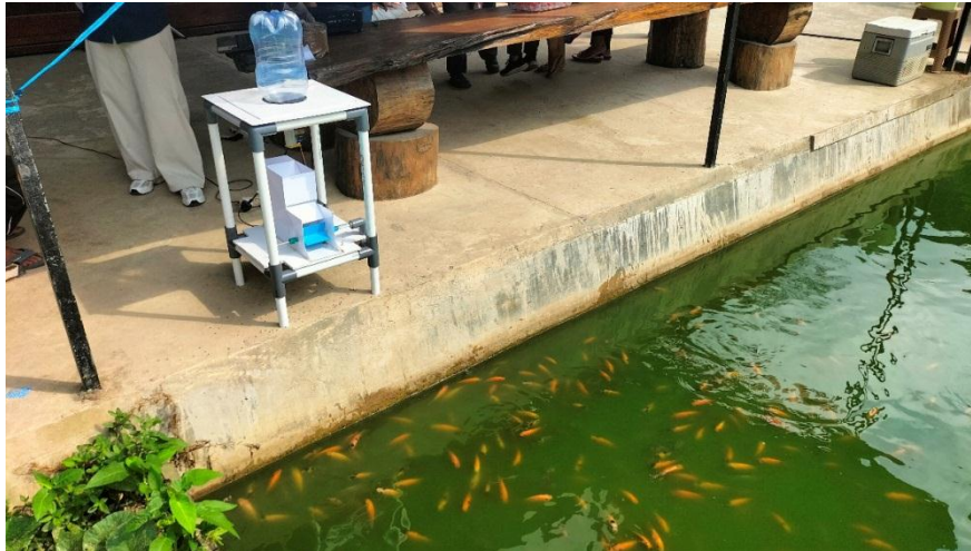
Gambar 4. Prototype pakan ikan otomatis yang dipasang pada kolam percontohan
