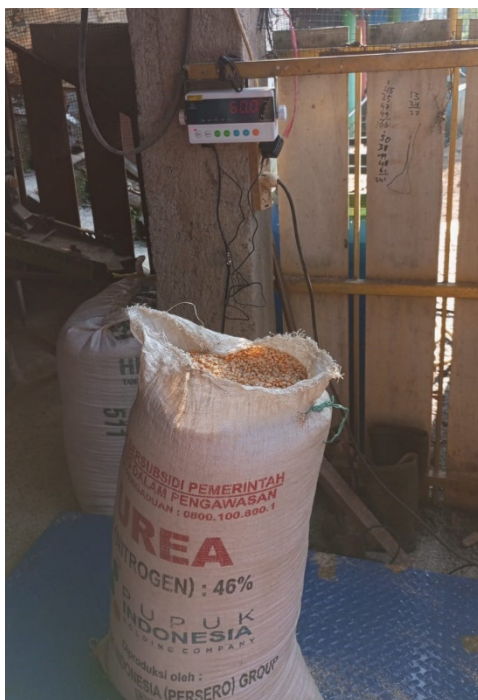
Gambar 3. Uji Coba Timbangan Digital untuk Hasil Tani
